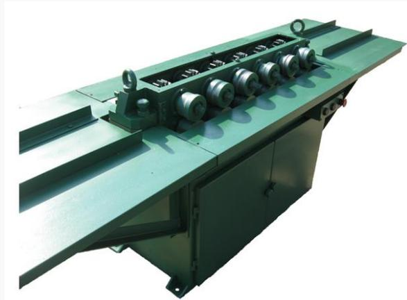
Фальцепрокатный танок СФП-6 предназначен для прокатки фальцев, соединительных реек, тонкостенных профилей, элементов защелочного соединения применяемых при изготовлении круглых и прямоугольных воздуховодов, а также для прокатки сложных сечений по индивидуальному заказу. Механизм работает с тонколистовой низкоуглеродистой сталью (марка стали СТ-0 до СТ-20), оцинкованной и без покрытия, а также нержавеющей сталью с толщиной листа от 0,5 до 1 мм.
