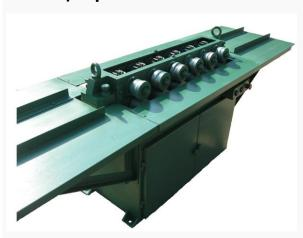
Фальцепрокатныйтанок СФП-10 предназначен для прокатки фальцев, соединительных реек, тонкостенных профилей, элементов защелочногосоединения применяемых при изготовлении круглых и прямоугольных воздуховодов, а также для прокатки сложных сечении по индивидуальному заказу. Механизм работает с тонколистовой низкоуглеродистой сталью (марка стали СТ-0 до СТ-20), оцинкованной и без покрытия, а также нержавеющей сталью с толщиной листа от 0,5 до 1 мм.
