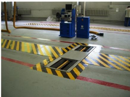
Стационарная универсальная линия технического контроля легковых и грузовых автомобилей, автобусов и автопоездов с нагрузкой на ось до 13 т. Линия предназначена для контроля технического состояния автотранспортных средств при проведении технического осмотра, инспекционного контроля, а также может использоваться для проведения ремонтных и регулировочных работ.
