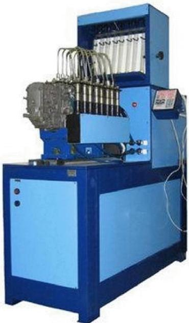
Стенд с асинхронным электродвигателем (с преобразователем частоты «MITSUBISHI») позволяет производить регулировку и диагностику ТНВД дизельных двигателей отечественного и зарубежного производства с количеством секций до 8.
