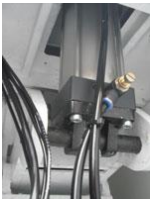
Подача пилы при помощи пневмоцилиндра
