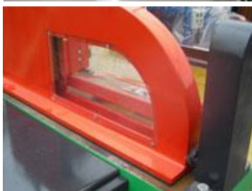
Автоматический прижим с приводом от пневмоцилиндра
