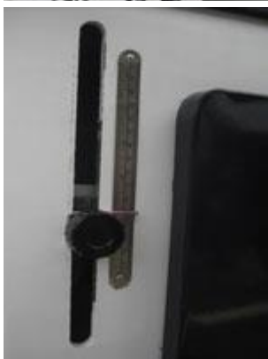
Регулировка высоты вылета пилы
