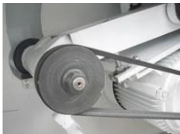
Привод пилы от двигателя мощностью 5,5 кВт через клиноременную передачу.
