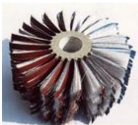
Щеточный шлифовальный барабан для конечной (чистовой) обработки
