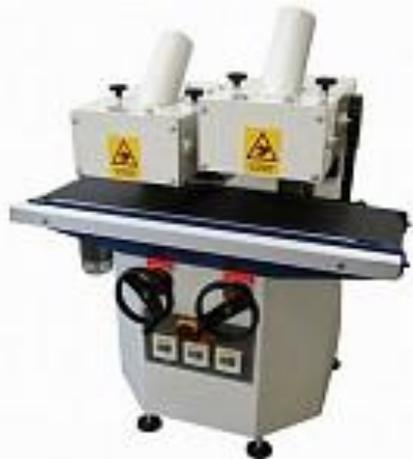
Для искусственного старения древесины по пласти с помощью специальных абразивных щеток. Широко применяется в различных производствах: для обработки балок, вагонки, рамок для картин, деревянного пола, различных профилей. Область применения готовых изделий: декоративная отделка стен, перекрытий, полового настила и паркета стилизованная под старину - для баров, ресторанов, коттеджных домов и т.д.
