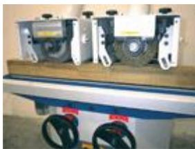
**Прижимные ролики регулируются в зависимости от износа щетки**
