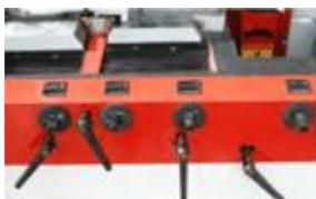
Настройка всех шпинделей легко и удобно производится с передней панели станка, не открывая защитного ограждения. Отсчет размеров настройки производится по цифровым индикаторам с точностью 0,1 мм.
