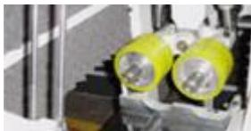
На выходе заготовку протаскивают две пары высокопрочных полиуретановых роликов, не позволяющие повредить заготовку, и нижние приводные гладкие ролики. Обеспечивается высокое качество обработанной поверхности.
