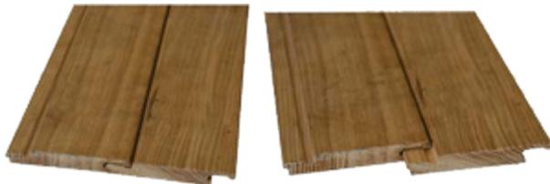
Система с замковым соединением "Click" не требует склеивания при укладке. Специально разработанная конструкция со шпунтом и гребнем позволяет скреплять панели покрытия быстро, удобно и аккуратно, вставляя их одна в другую до защёлкивания. Таким образом, система "Click" обеспечивает выполнение работы наполовину быстрее, чем при настиле традиционных клеевых полов.
