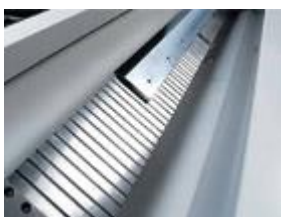
Плита для фиксации ножей
