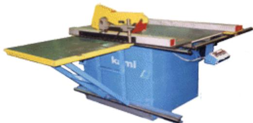
Станок предназначен для продольной, поперечной и под углом распиловки досок, брусков, древесных, плитных и листовых материалов.
