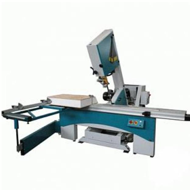
Станок предназначен для прямолинейного пиления и под углом ленточными пилами сэндвич-панелией, досок, щитов, листовых материалов на заготовки.
