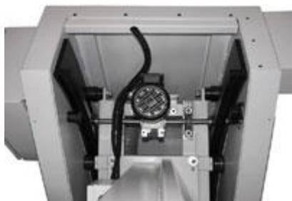
Наклон пильного узла с приводом от электродвигателя через передачу шестерня-зубчатая рейка
