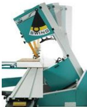
Механический индикатор наклона пильного узла
