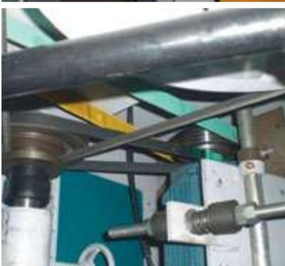
Скорость вращения инструмента и скорость осцилляции регулируются отдельными ремнями. Это позволяет увеличить скорость вращения инструмента до 11000 об/мин, а скорость осцилляции изменять в диапазоне 180-240 движений/мин
