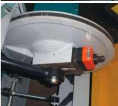
Ширина паза удобно регулируется с помощью цифрового счетчика
