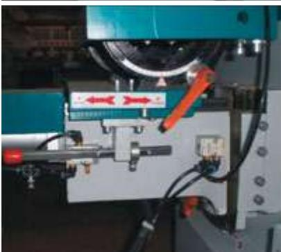
Глубина паза регулируется концевым выключателем
