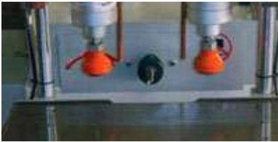
Каждый стол оснащен двумя пневмоприжимами. Обдув детали сжатым воздухом во время обработки.
