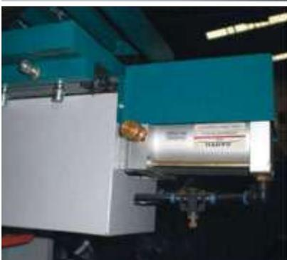
Гидропневматическая подача столов обеспечивает плавность и равномерность хода даже при обработке твердых пород древесины
