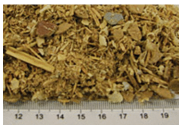
Отходы ЛДСП после дробления кусковых отходов.
